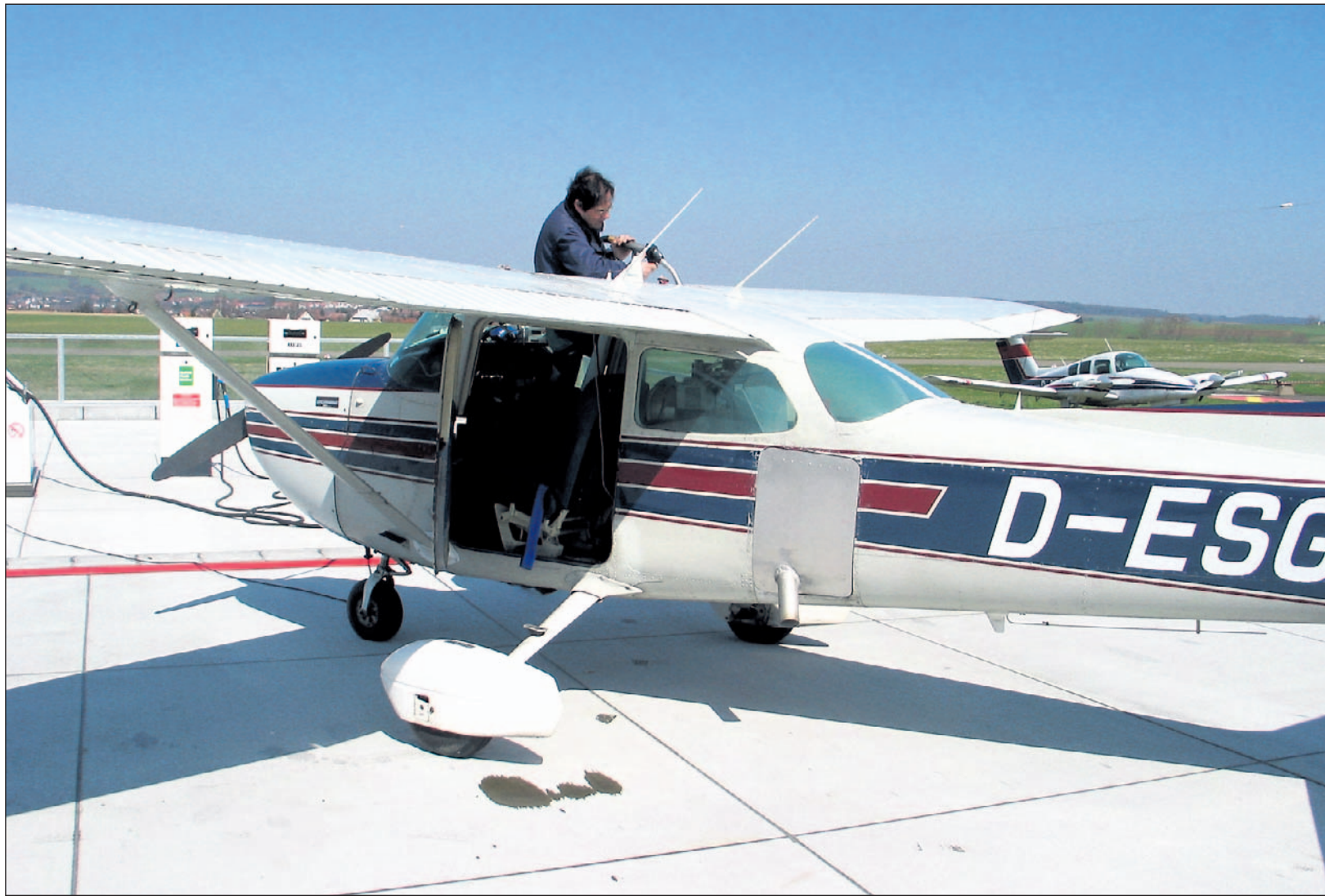
Nur auf den ersten Blick ein Sportflugzeug: Die Cessna 172, Baujahr 1979. An der Seite ist die Abwurföffnung zu sehen. Betankt wird von oben.
